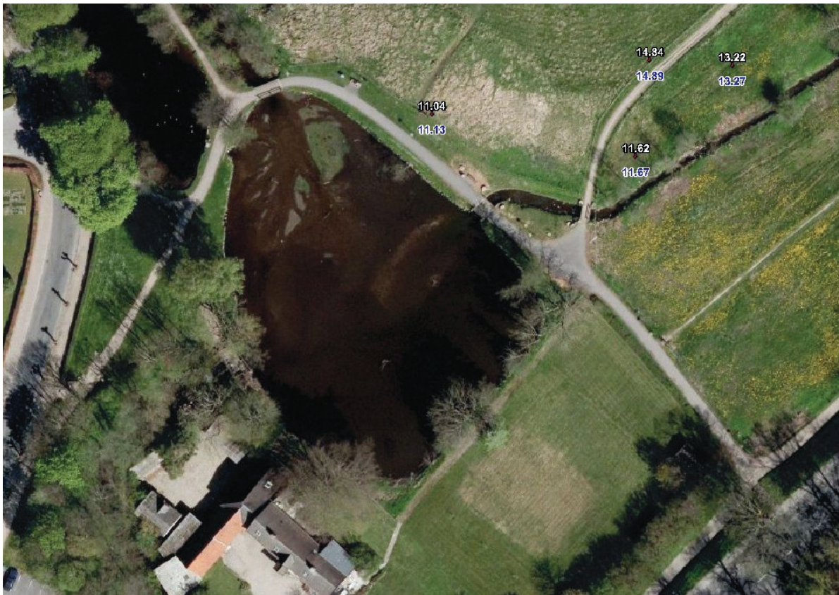
Figur 9 Sammenligning af opmålte terrænpunkter med den digitale højdemodel. Hvide tal er opmålingen, mens blå tal er hvad den digitale højdemodel angiver af koter. Koter er angivet i m DVR90.
