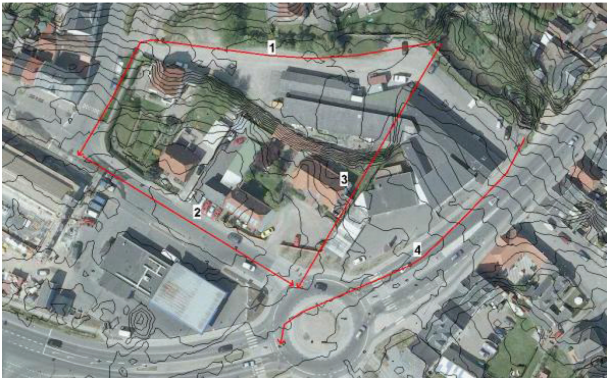
Figur 27 Terrænforhold ved nederste Ørkilds Mølle. Med rødt markeret tværsnit for flere muligheder for forløb af faunapassage - nyt vandløb for Kobberbækken.
