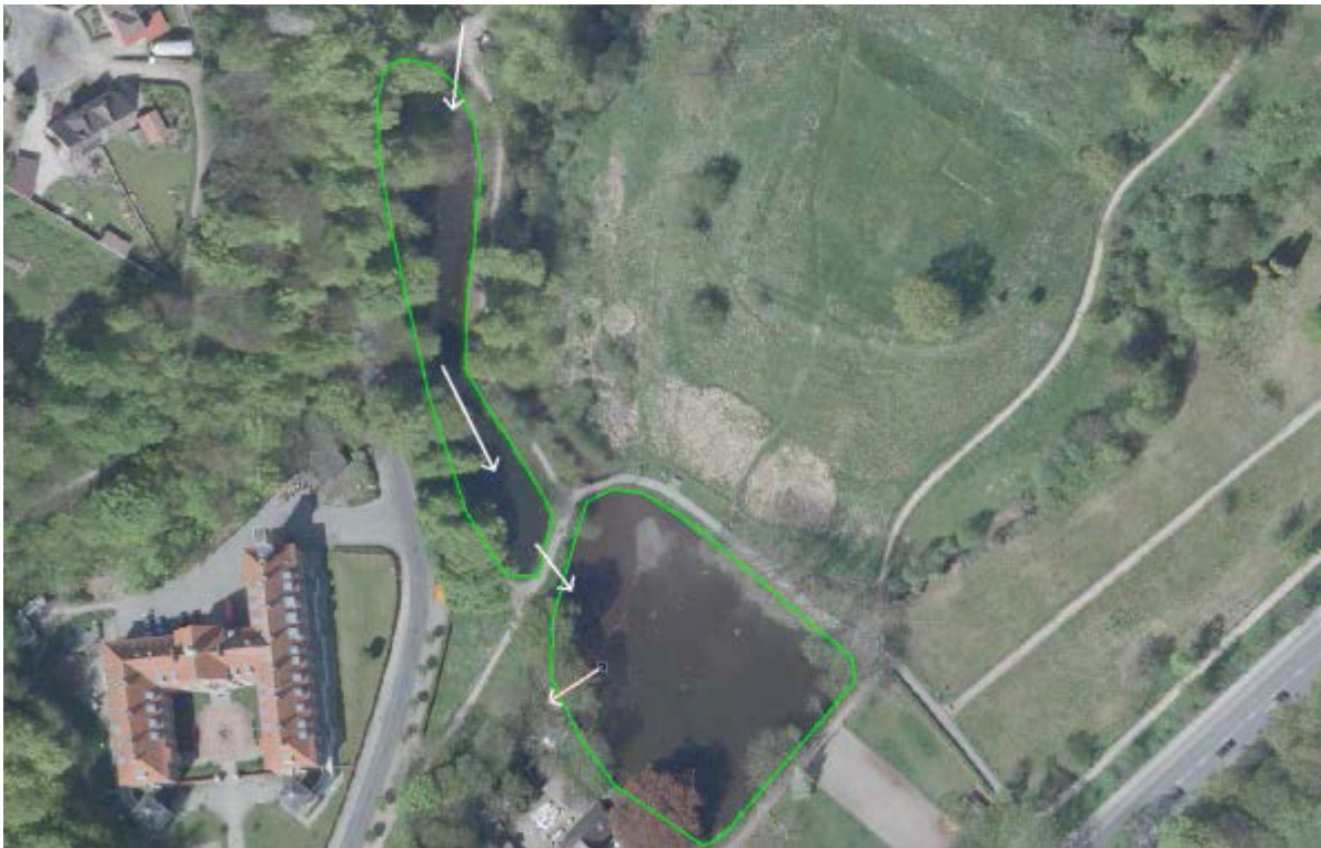
Figur 36 Det eksisterende indtag til mølledammen og vandets vej markeret med pile.
