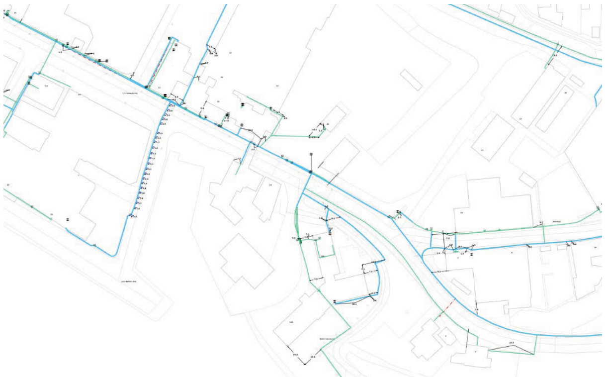
Figur 66 TDC kabler ved Strækning 3b
