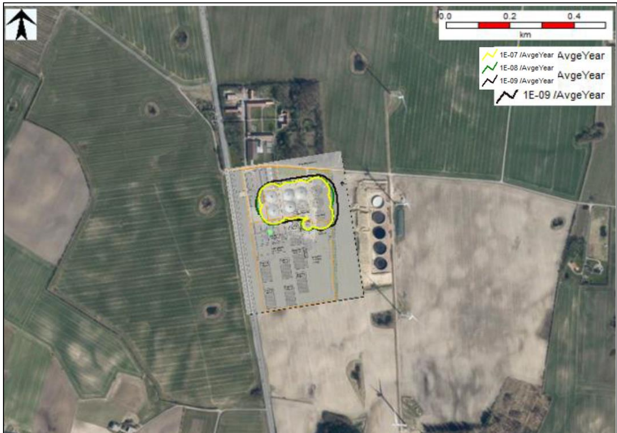
Figure 4.1 Stedbunden risiko - ISO-kurver for modelanlægget. Det ses at større hændelser på modelanlægget, der vil ende i et dødsfald, ikke er tilstede inde for anlæggets voldsystem, (mangel på rød kurve ). Det ses ligeledes at større hændelser der vil ende ud i et dødsfald én gang hver 1 milliard år ligger i en begrænset afstand fra anlæggets matrikulære grænse ( sort kurve ). I ovenstående beregninger er virksomhedens sikkerhedsudstyr og barrierer ikke medregnet.
