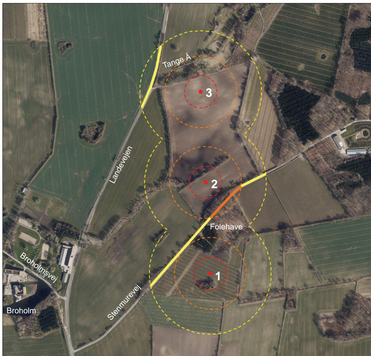
Figur 2.8. Kort med projektforslagets mølleplaceringer i forhold til Landevejen og Stenmurevej med angivelse af arealer med vingeoverslag (rød) samt arealer inden for en afstand af henholdsvis 150 meter (orange) og 255 meter (gul).
