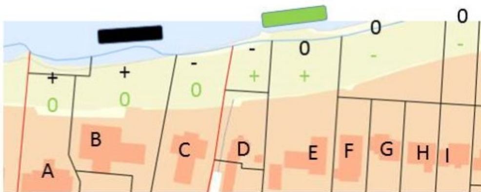
Figur 10 Bølgebryderes positive og negative effekt på kystlinjens tilbagerykning
