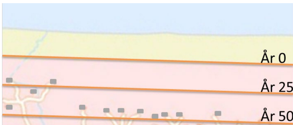
Figur 9 Eksempel på differentieret nytteværdi over tid. Orange linjer viser skræntens tilbagerykning i løbet af 50 år
