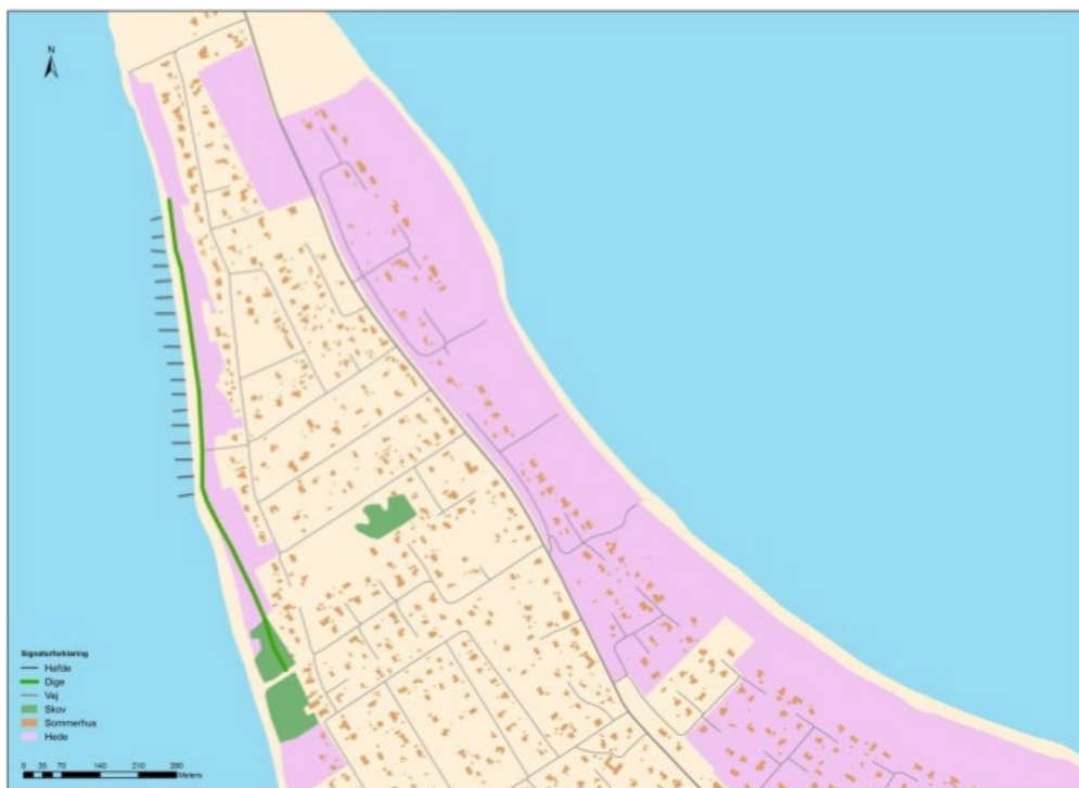
Figur A7 Projektscenarie 1: Dige med høfder foran
