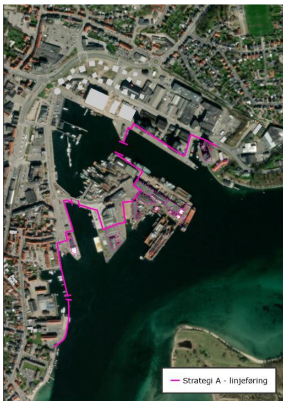
Figur 27: Stormflodsbeskyttelsesstrategi A - linjeføring
