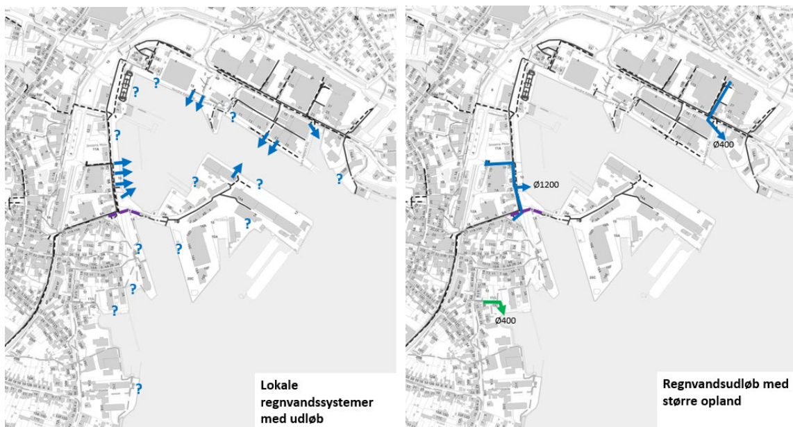
Figur 25: Regnvandsudløb med direkte afstrømning til havnebassiner. Signatur: Blå = regnvandsudløb; grøn = fællessystemsudløb
