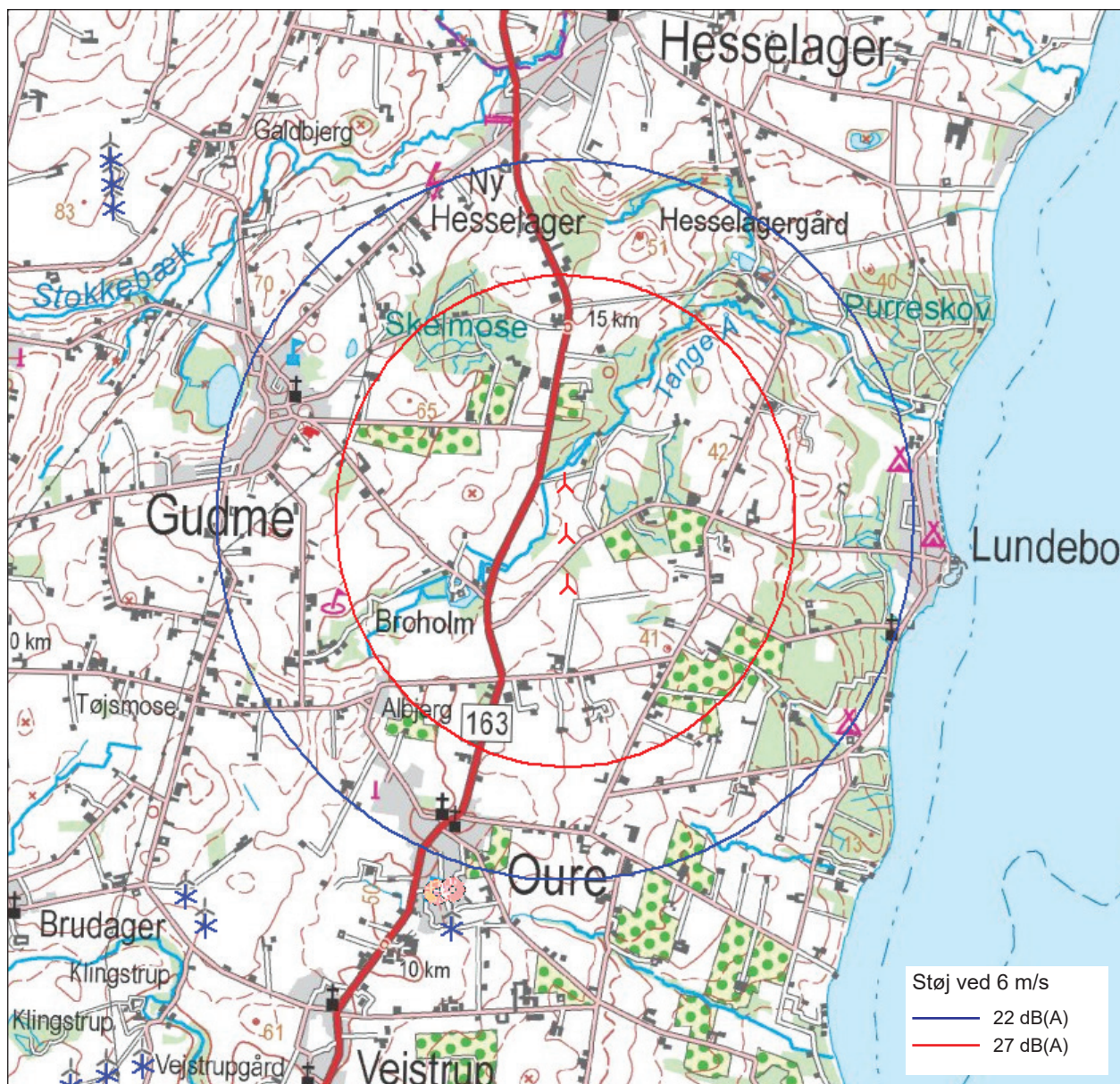
Figur D. Analyse af støjpåvirkning (udendørs opholdsareal) ved eksisterende møller i det omkringliggende landskab ved opstilling af Vestas-møller med 136 meter rotor med støjdæmpning.
