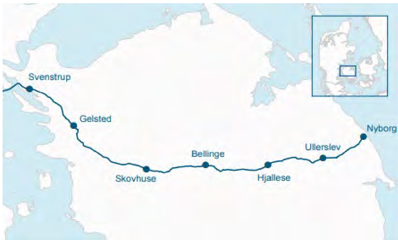
Figur 25: Kortet viser den strækning, hvor der lægges en ny rørledning i jorden. Placeringen af kompressorstationer og linjeventilstationer, som bruges til regulering og vedligehold er vist med blå prikker 17 .
