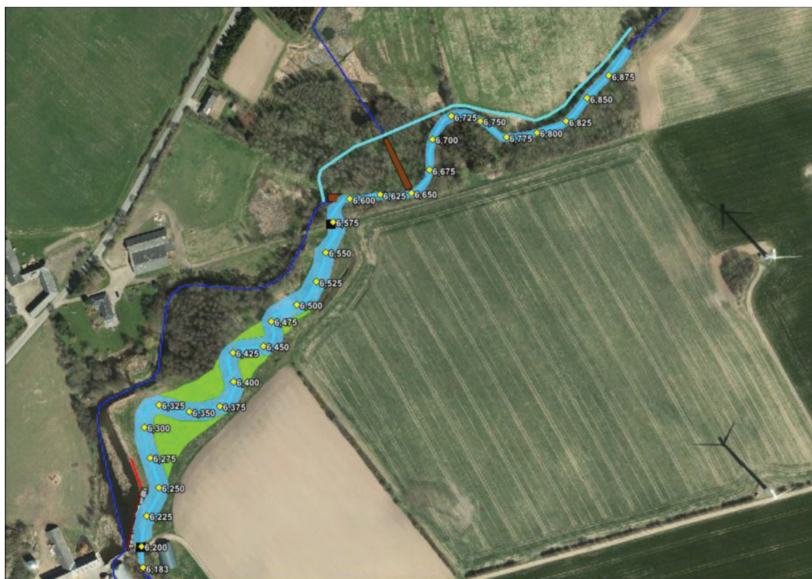
Figur 40 Projektforslag scenarie 3. Nyt forløb af Hundstrup Å etableres øst for den bevarede mølledam som sikres ved etablering af en spuns (Bilag 14)
