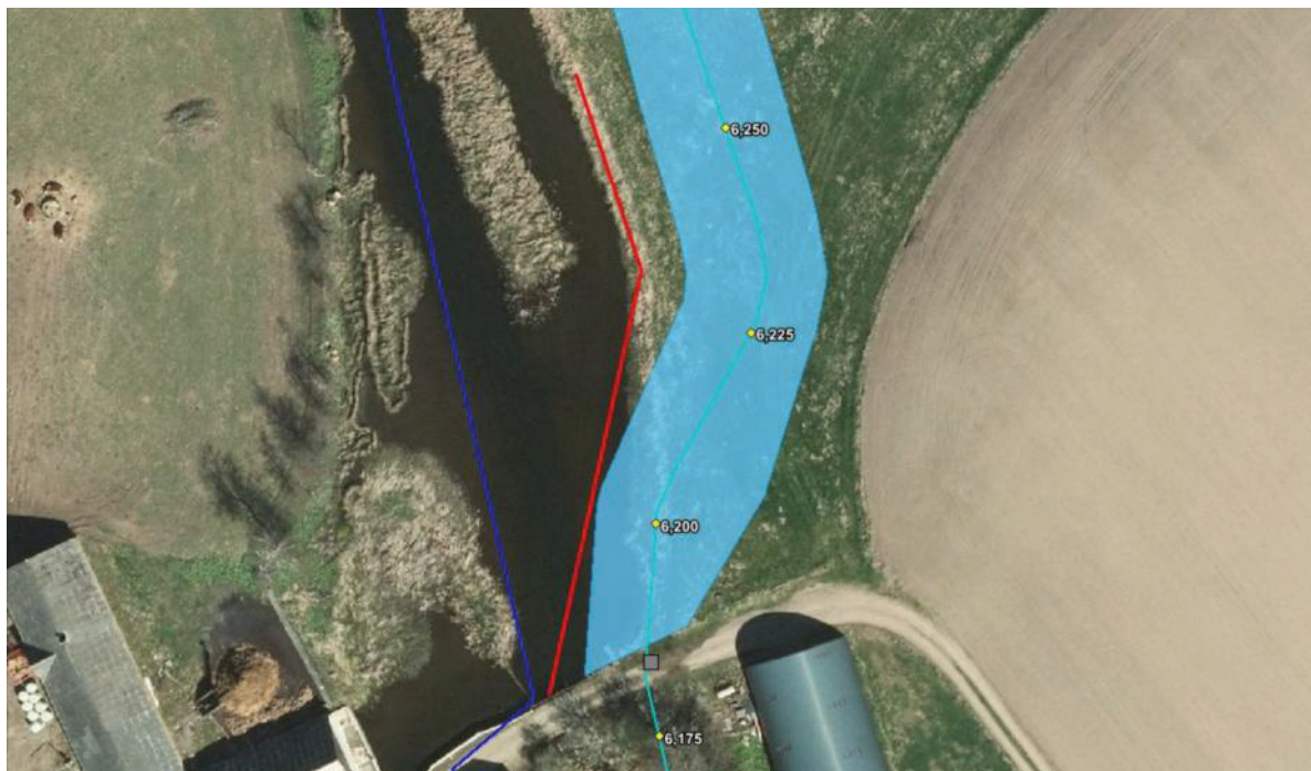
Figur 31 Placering af stålspons til adskillelse af mølledam og vandløb (vist med rød streg)
