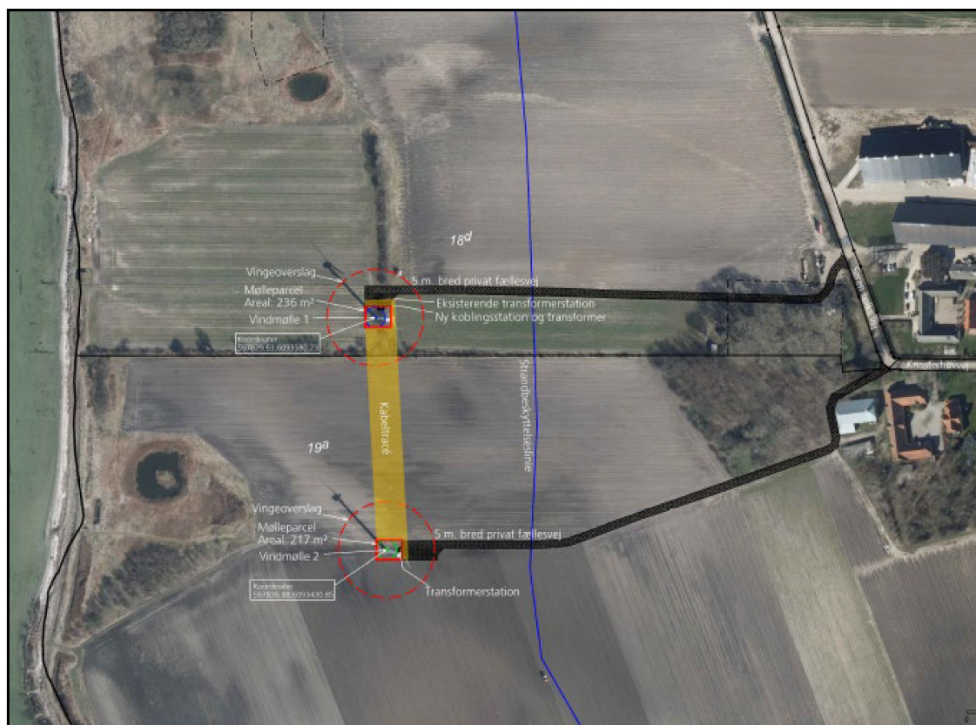
Figur 1 Placering af møller, transformer- og koblingsstation, kabeltracé og adgangsveje i projektområdet. (Kort 2.3, Miljøkonsekvensrapport)
