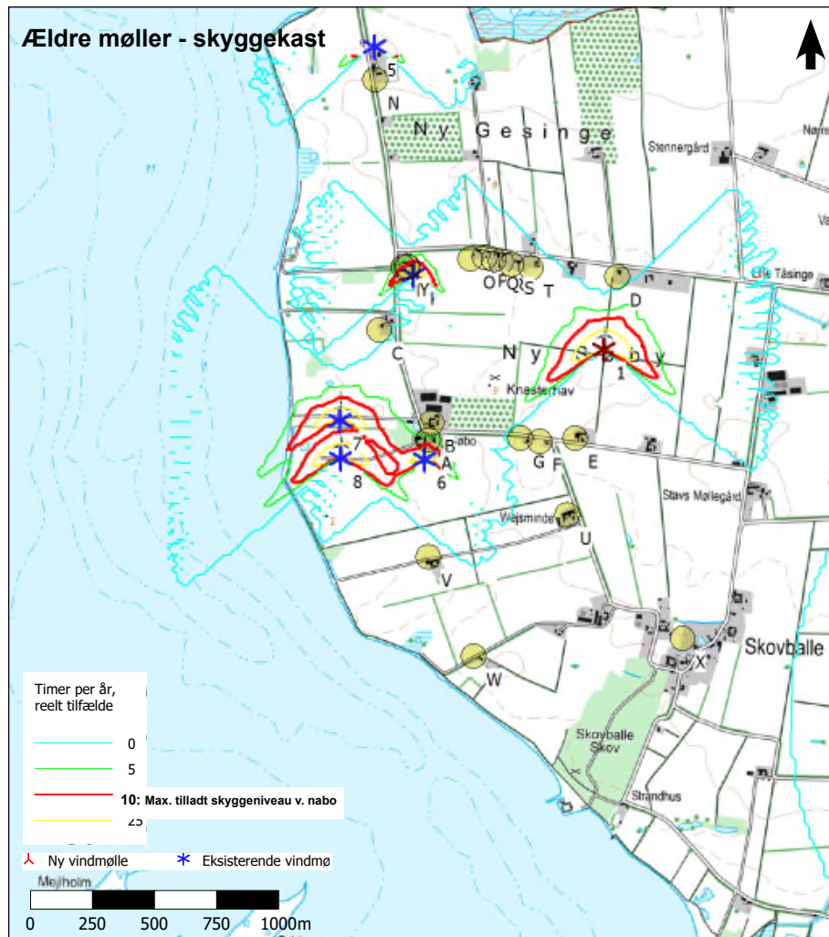
Kort 3.6. Isoliner for skyggekast i timer pr. år for ældre møller samt projektforslag med DW61 som mølletype. I situationen "ingen møller" er der en mindre påvirkning, som alene skyldes husstandsvindmøller. Den røde linje afgrænser det område, som teoretisk vil påvirkes med mere end 10 timers skyggekast i et gennemsnitsår, reel værdi, fra ældre møller eller projektforslag inkl. områdets husstandsvindmøller. Ingen beboelser ud over møllejerne er beregnet at få mere end 10 timers skyggekast fra projektforslagets møller.
