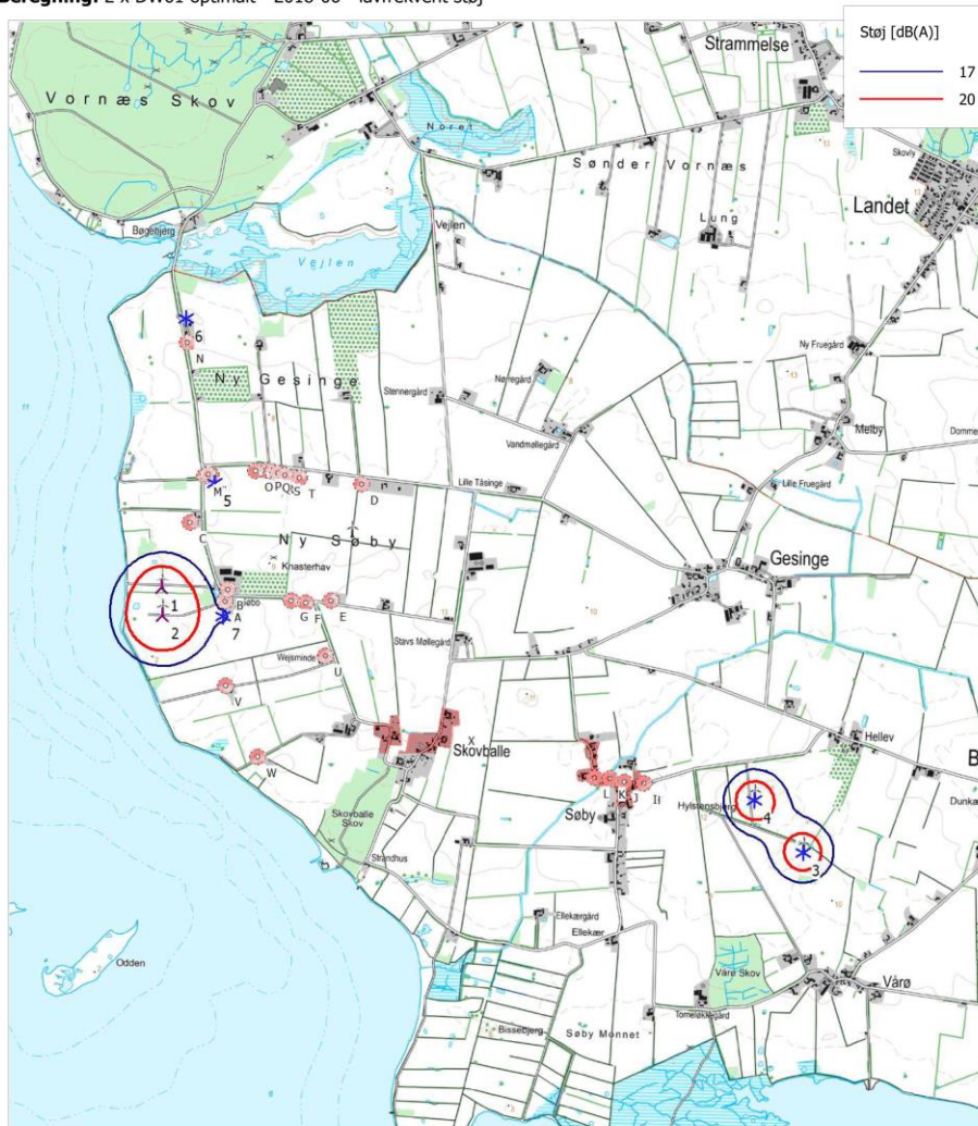
Kort: KMS - Topografisk 1:25.000, Udskriftsmålestok 1:30.000, Kortcentrum UTM (north)-ETRS89 Zone: 32 Øst: 599.606,64 Nord: 6.093.633,52 ▲ Ny vindmølle * Eksisterende vindmølle ● Støj følsomt område Støjregningsmetode: Dansk Lavfrekvent 2011 og 2015. Vindhastighed: 6,0 m/s Højde over havoverflade fra aktivt linie objekt
