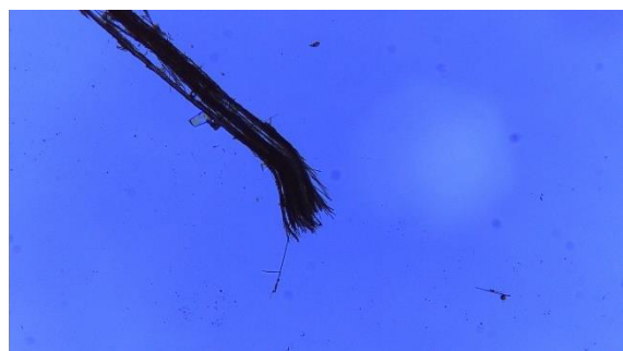
#2 Asbestfiber i P28 (100x forstørrelse).
