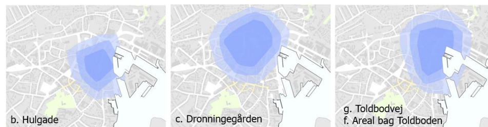
Figur 6. Gangafstande til P-hus vist for 300m, 400m og 500m. Oplandet er beregnet på vej- og stinet og dermed ikke i fugleflugt-linje med fast radius.
