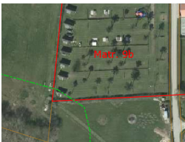
Reduceret skovbyggelinje vist med grøn stiplede linje 30 m fra skovbrynet ved Grønneskov.
