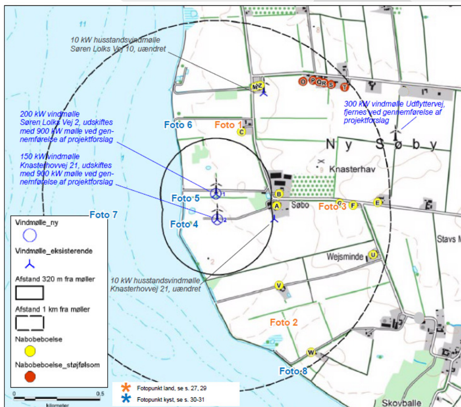
Kort 3.1 Placering af nye vindmøller (1 og 2), tidligere vindmøller samt beregningspunkter ved nærmeste beboelser (bogstav). Beregningspunkter omfattet af beskyttelseskrav for støjfølsom arealanvendelse er vist på rød baggrund, og beregningspunkter i det åbne land er vist på gul baggrund. Afstandskrav til nabobeboelse på 4x80=320 m samt afgrænsning på 1 km fra de ansøgte møller er vist med sort og sort stiplede streg. Fotopunkter, der behandles i afsnit 3.4 og 3.2, er markeret.
