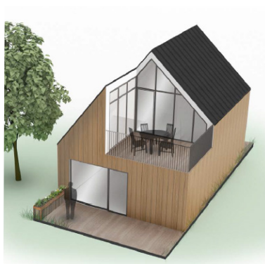
Figur 3 - Tagterrasser Illustration af princippet for tagterrasser.
