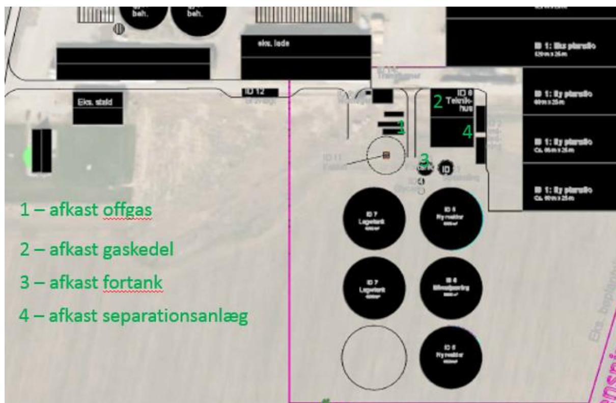
Figur 18 Placering af lugtafkast på Andekærgård Biogas.
