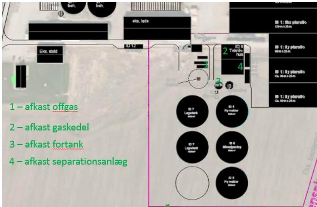
Figur 15 Placering af lugtafkast på Andekærgård Biogas.
