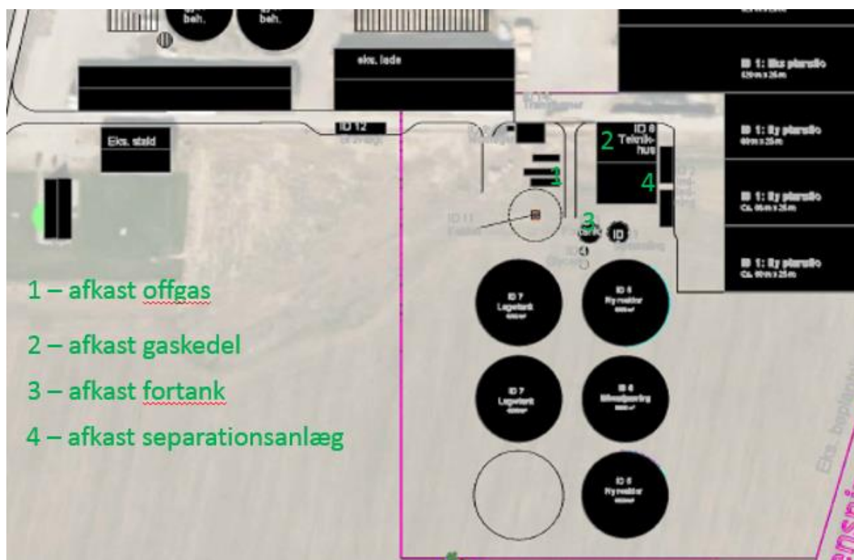
Figur 18 Placering af lugtafkast på Andekærgård Biogas.
