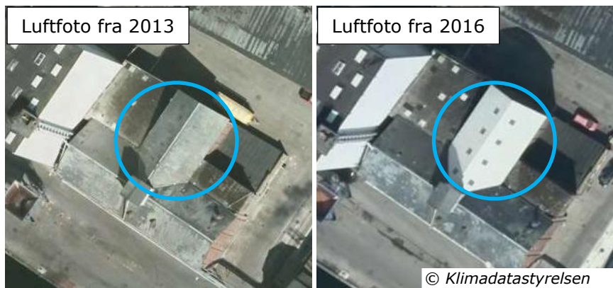
Figur 3: Del af tagplade på pakhus 9 udskiftet efter storm.
