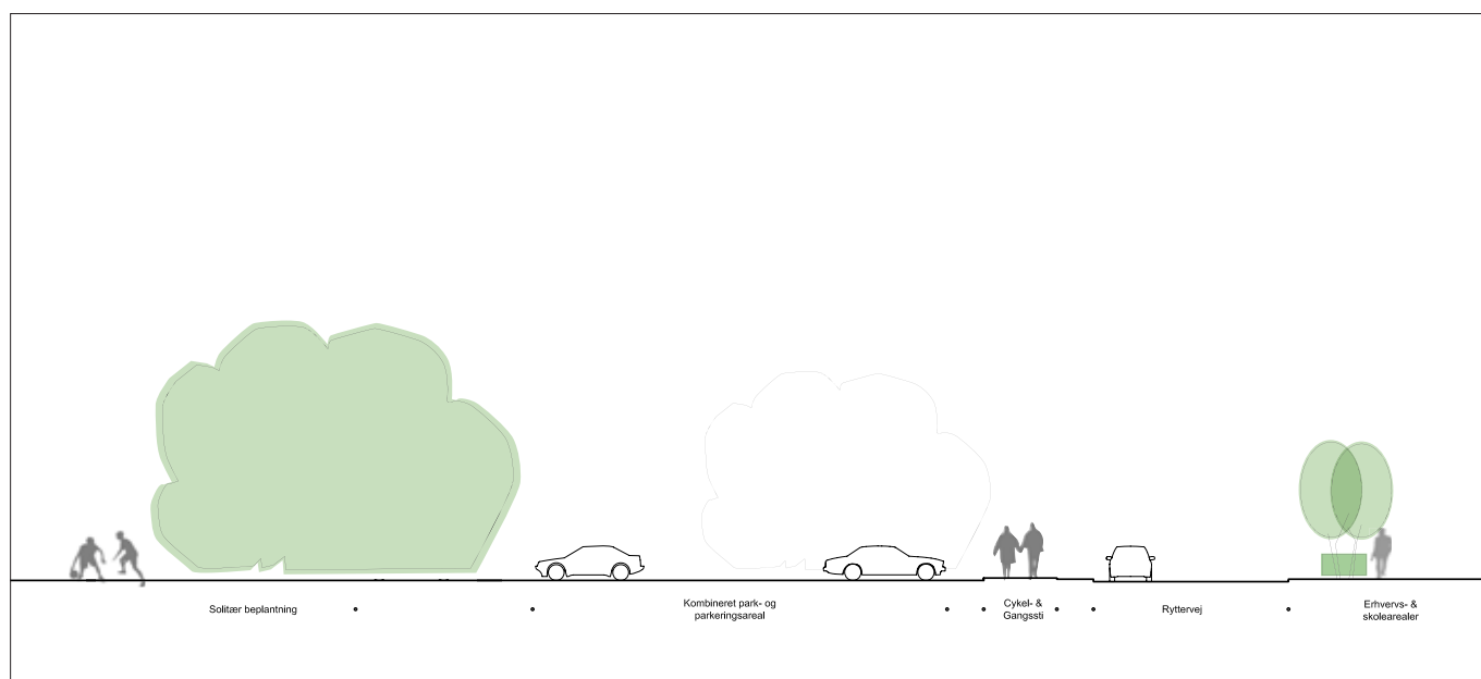
Figur 10. Principssnit af parkeringsområde og sammenhængen til Ryttervej.
