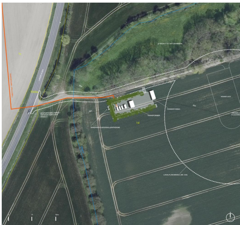
Figur 2: Kortudsnit med indtegnet oversigt over transformerstationens layout.
