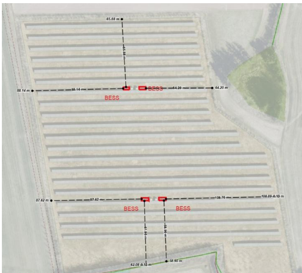
Figur 1: Placering af BESS-anlæg ved eksisterende solcelleanlæg ved Staurkilde, Ulbølle.
