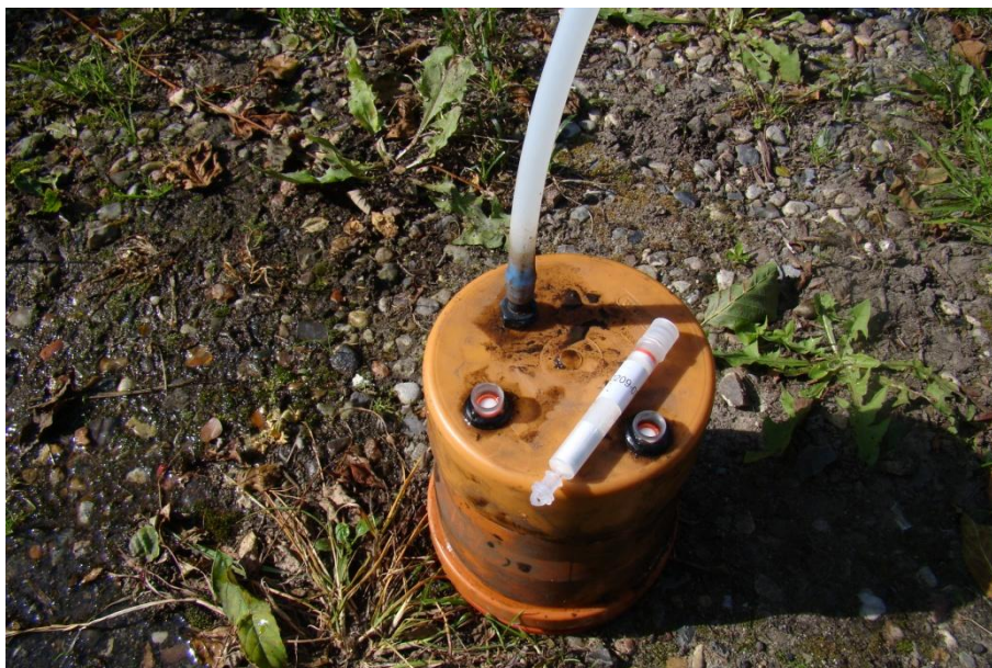
Billede af prøveudtageren (Sorbicellen) og røret hvori de placeres. Foto: Anne Sloth
